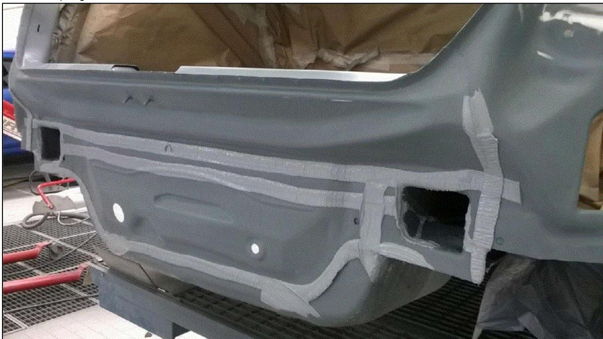
**Abdichtungen sind bereits nach 25-45 min überlackierbar (nass in nass)**
