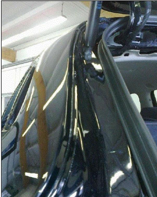
Bild 15: Beispiel glatte Dichtnähte
