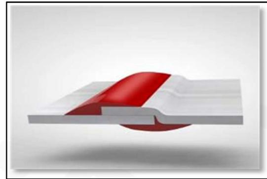
Bei den meisten Verbindungstechniken muss zur Verhinderung von Korrosion z. B. durch Umwelteinflüsse zusätzlich abgedichtet werden.
