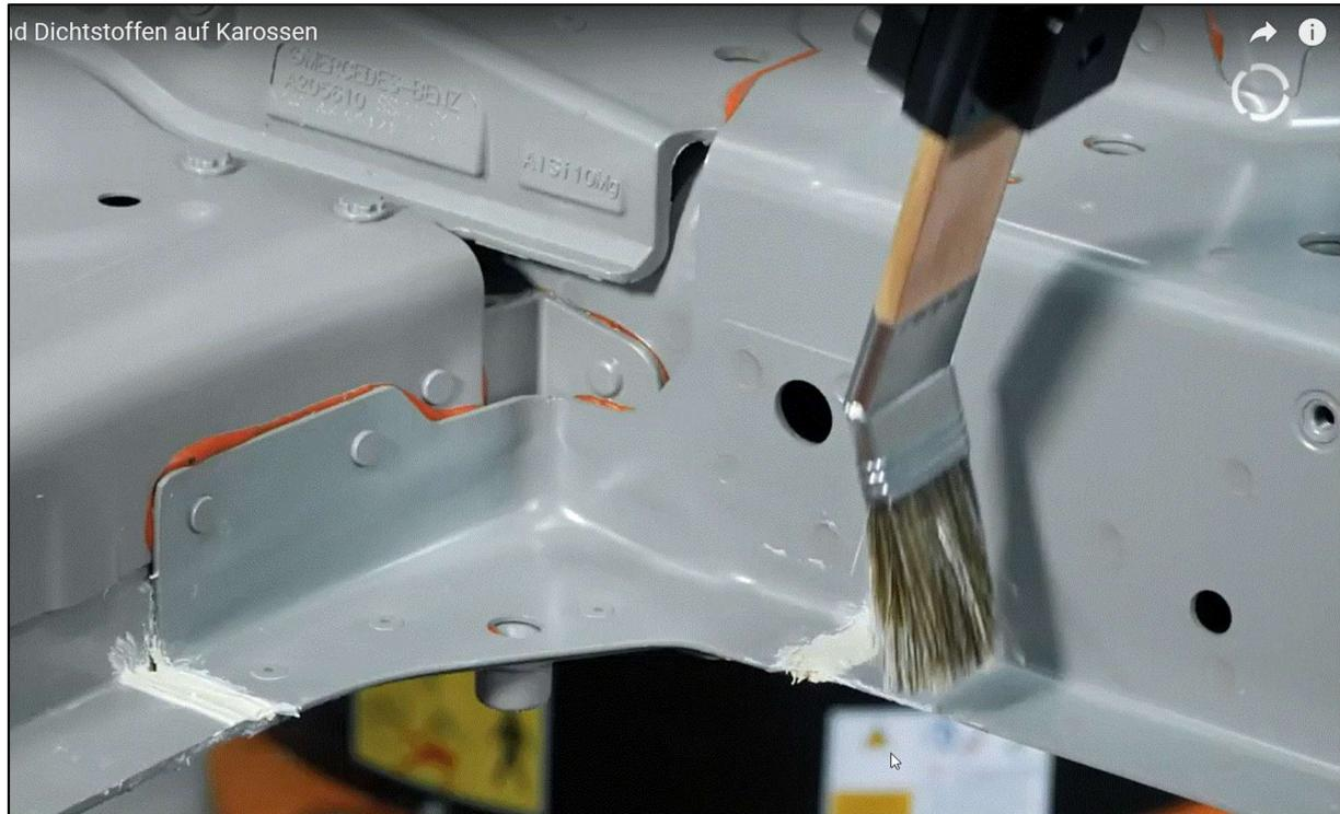
Neben vollautomatisiertem Laservermessen und Einstellung der Düsen, individuell auf jedes Karosserie-segment, sind vollautomatisierte Abdichtroboter in der Lage, alle erwünschten Abdichtungen präzise zu applizieren bzw. zu verspritzen. Wo erforderlich können diese Roboter auch so angelernt und programmiert werden, dass das Verstreichen von Dichtnähten vollautomatisiert möglich ist.
