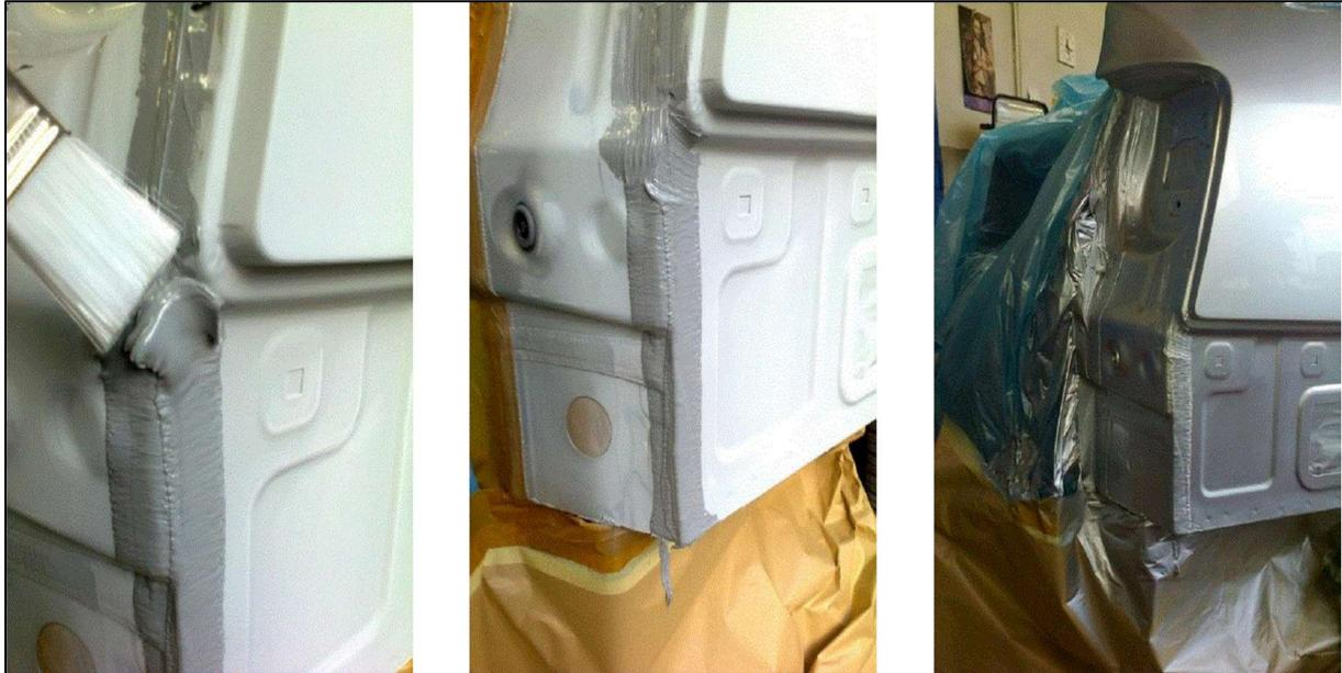
Bild 17: Beispiel geriffelte Dichtnahtstrukturen
